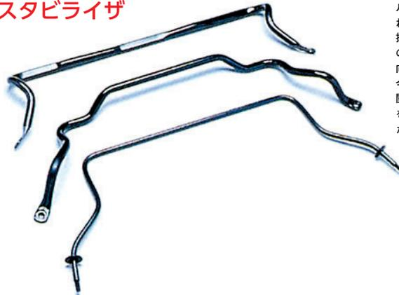
左右のサスペンションアームをコの字型に成形したばね鋼で連結し、自動車が旋回して車体が傾いた時(ロール現象)に発生する左右輪のストローク差に応じて、ばね作用を生じるばね鋼の振れの反発力によりロールを抑える、それが当社が製造する自動車用スタビライザの特徴です。四輪の接地性や高速での直進安定性が向上し、横風による「ふらつき」を抑制します。今まで培ってきた専門技術を土台にしてさらなる技術開発に努め、また徹底した品質管理によるものづくりを展開し、今後もより多くのお客様に、より満足していただける製品を提供していきます。
